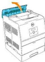
3. Libere las palancas situadas a ambos lados y retire el material de impresión atascado.
