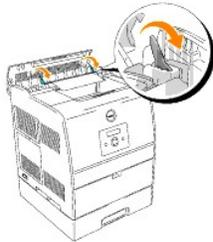
**PRECAUCIÓN:** No toque las palancas exteriores situadas a ambos lados de la unidad fusota, que se utilizan para retirar o instalar dicha unidad fusota.
