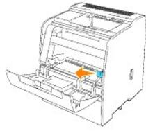
3. Sostenga la varilla de limpieza y desplácela hacia delante y hacia atrás una vez para limpiar el interior de la impresora.
