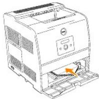
Para cargar sobres de menos de 8.66" (220 mm) de ancho, inserte los sobres con las solapas abiertas y hacia la parte frontal de la impresora, y con la cara de impresión recomendada boca arriba.
