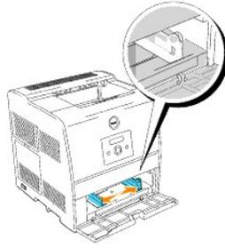
3. Coloque el material de impresión en el alimentador con la cara de impresión recomendada boca arriba.
